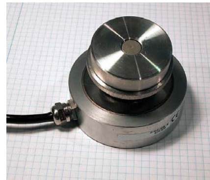
RLC er her vist med en højde justerbar fod for 250kg - 1t.
